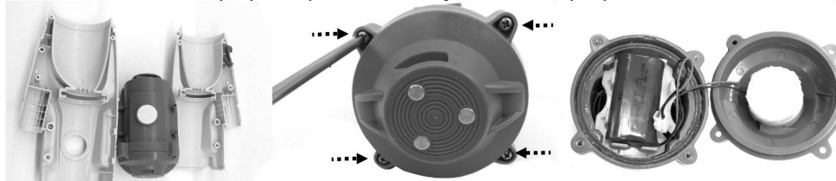
4. Quitar el paquete de batería de la cámara principal. Para quitar el paquete de batería, apreté el clip del conector y dispáralo. NOTA: Envuelva inmediatamente el conector con cinta aislante para evitar cortocircuitos causados por el contacto de los dos polos del cable.
