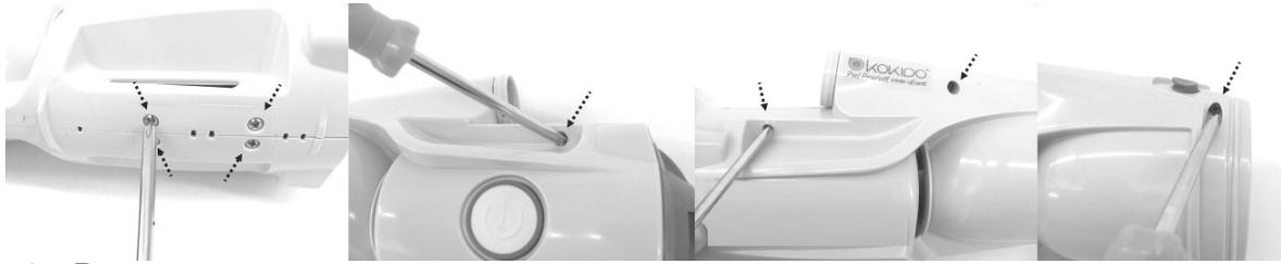
3. Разделите корпус на две половины для доступа к основной камере. Чтобы снять торцевую крышку и получить доступ к аккумулятору, используйте отвертку Phillips.
