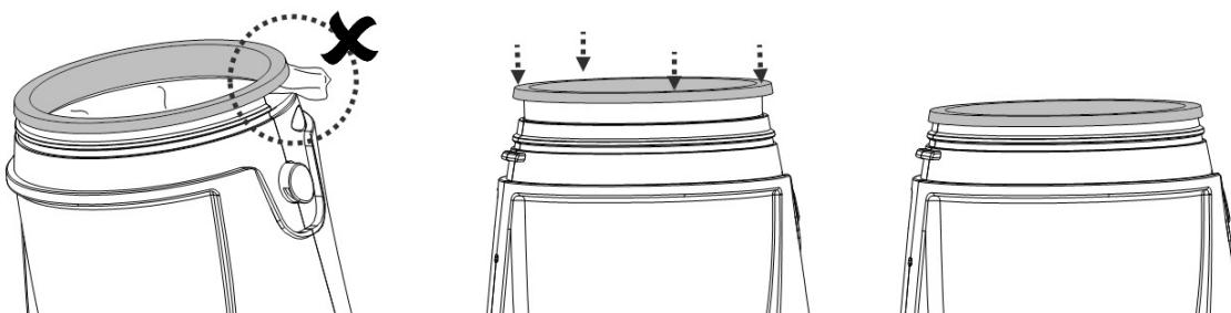
Para re-instalar el contenedor transparente al cuerpo principal, alinee el orificio del lado trasero con el gancho del cuerpo principal y apreté el contenedor transparente en el cuerpo principal. Asegúrese que el orificio de bloqueo del contenedor transparente quede fijado con el botón de bloqueo.
