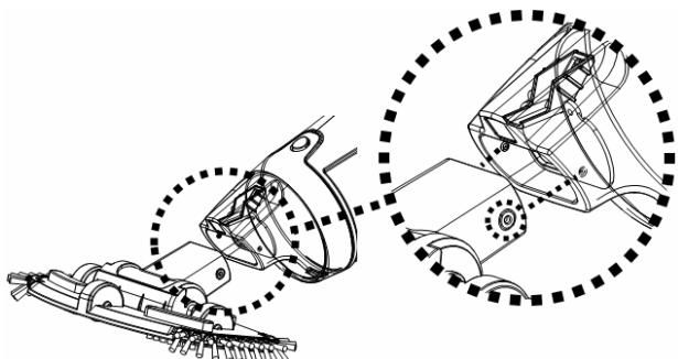
**ПРИМЕЧАНИЕ.** Чтобы заменить щетки на всасывающей головке, поднимите один конец и вытащите щетку, чтобы освободить место для новой.
