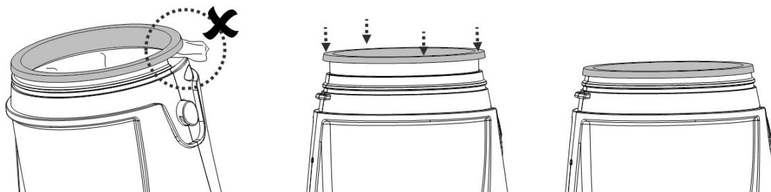
Для того, чтобы повторно установить контейнер, сначала совместите паз контейнера с крючком на основном корпусе, а затем втолкните контейнер в основной корпус. Убедитесь, что запирающее отверстие на прозрачном контейнере закреплено с помощью кнопки-фиксатора.
