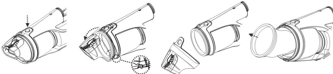
**¡PRECAUCIÓN!** Sustituya el bolsa filtrante dañado inmediatamente por uno nuevo antes de volver a usar el dispositivo.
