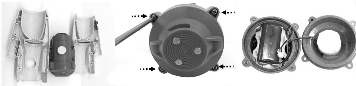
4. Выньте аккумулятор из основной камеры. Чтобы отсоединить батарею, нажмите зажим на коннекторе и достаньте ее. ПРИМЕЧАНИЕ. Немедленно оберните коннектор изоляционной лентой, чтобы избежать короткого замыкания, вызванного контактом обоих клемм.
