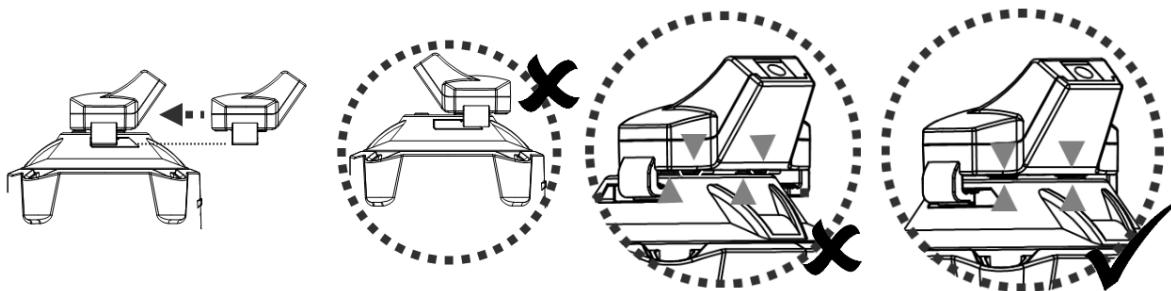
2. Brancher l'embout femelle de l'adaptateur externe dans l'orifice situé à l'arrière de la base de chargement.
