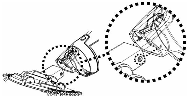
NOTE : Pour remplacer les brosses sur la tête d'aspiration, soulever l'extrémité et la pousser dehors pour laisser un espace pour une nouvelle.
