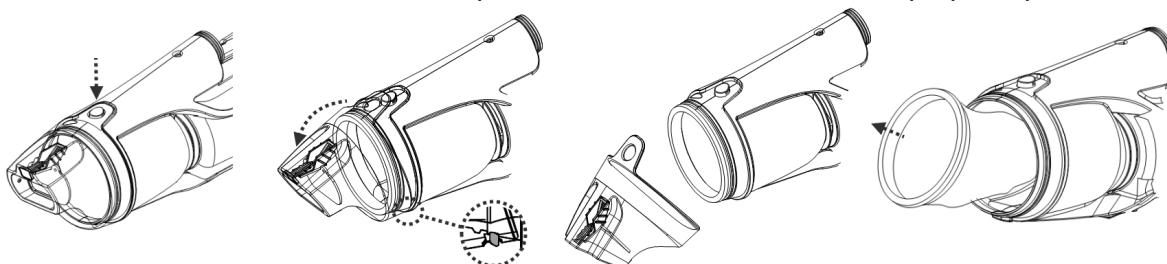
**MISE EN GARDE !** Remplacer immédiatement un filtre endommagé par un nouveau avant la prochaine opération.
