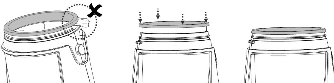
Pour repositionner le couvercle transparent, aligner le trou du couvercle avec le crochet sur le corps principal et appuyer les deux pièces pour les assembler. S'assurer que le couvercle transparent soit maintenu en place par le bouton de verrouillage du corps principal.
