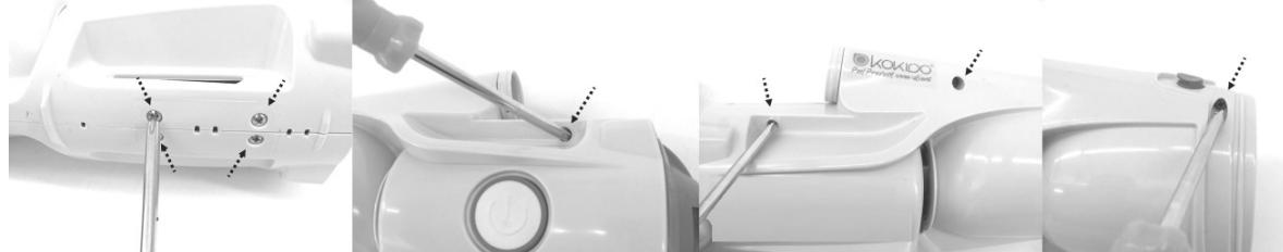
3. Separar el cuerpo en dos partes para acceder a la cámara principal. Utilice un destornillador Philips para quitar el anillo y acceder el paquete de baterías.
